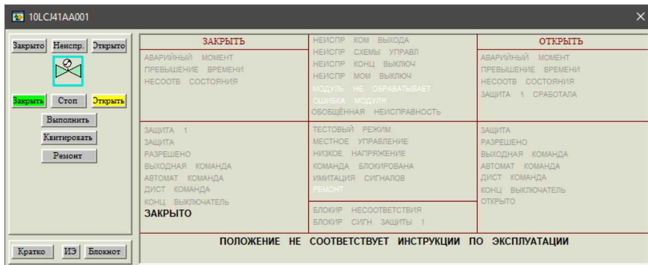
Рисунок Ошибка! Текст указанного стиля в документе отсутствует. 4 - Пример расширенного окна с сообщением о несоответствии положения арматуры состоянию энергоблока
